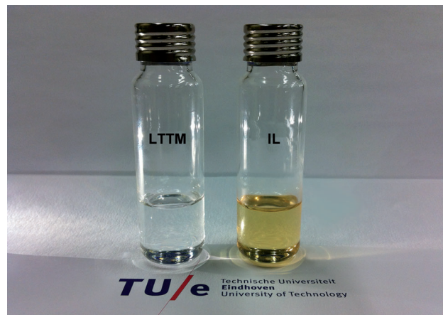
Abbildung 8. Proben der LTTM Milchsäure/Cholinchlorid (2:1; links) und der IL Cholinlactat (rechts) bei Raumtemperatur.
